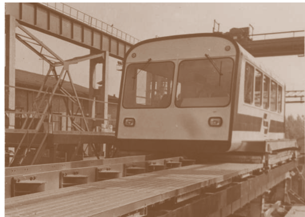
Монорельсова дорога завдовжки 525 м із двома лінійними двигунами по 5 кВт, 1967 рік The monorail 525 m long with two 5 kW linear motors, 1967
